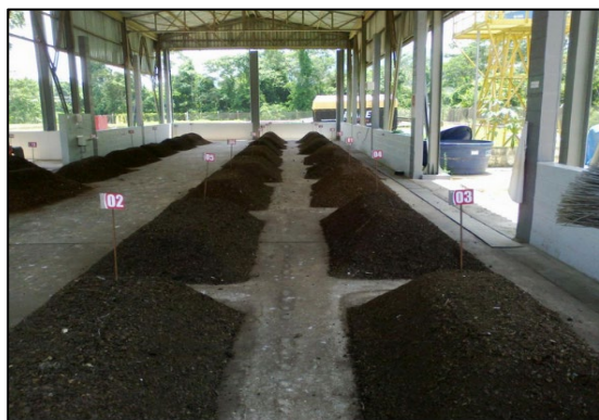
Figura 67 - Compostagem aeróbia de resíduos orgânicos em leiras. Compostagem mecânica de dejetos suínos.
