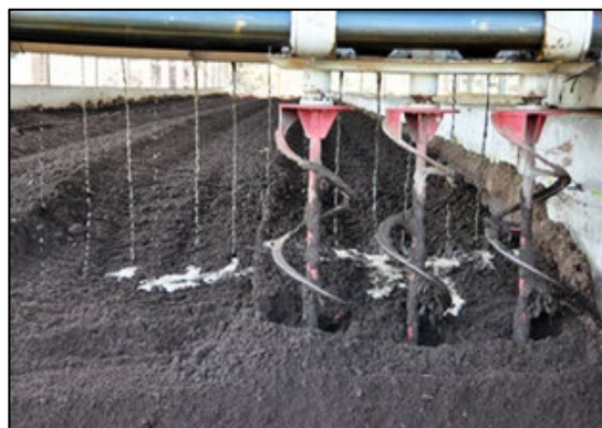
Figura 67 - Compostagem aeróbia de resíduos orgânicos em leiras. Compostagem mecânica de dejetos suínos.
