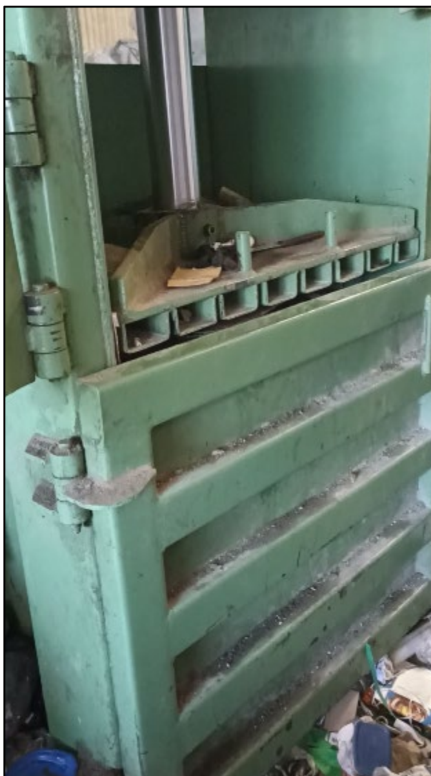
Figura 31 - Prensa industrial utilizada na compactação dos materiais recicláveis.
