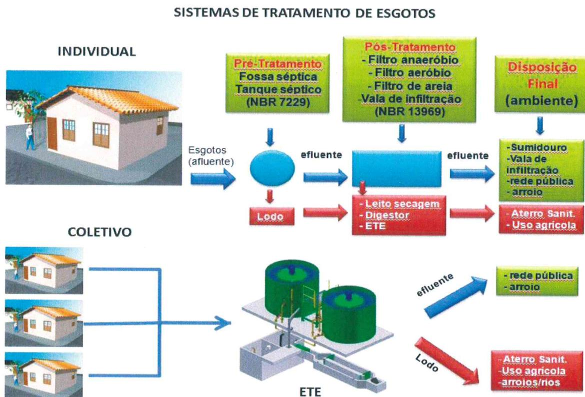
**Fig. 24 - Sistemas de tratamento de esgotos definidos pelas NBR 7229 e NBR 13969.**
